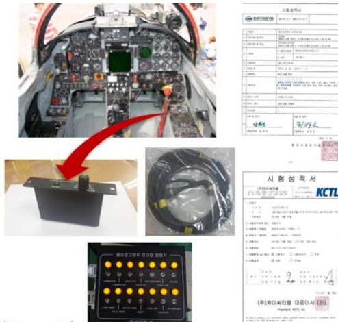
✓(K)F-5 조종석에 설치 되어, 점등으로 발생하는 경고 메시지를 헤드셋을 통하여 음성으로 경고를 알려 주는 장치
